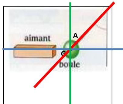
📖 La droite d'action de la force exercée par le fil sur la boule est la droite (AG) oblique (inclinée).
